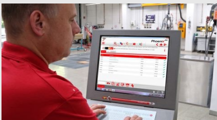
Sem fios, em movimento: Com o novo ColorDialog Phoenix, pode enviar-se os dados da medição do tom de cor, via WLAN, para o computador na sala de mistura.
