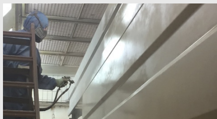
Nowy grunt Permafleet Special Primer marki Spies Hecker niezawierający chromianów zapewnia niezawodność procesu i jest przyjazny dla użytkownika.
