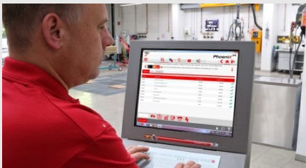
Inalámbrico: el nuevo ColorDialog Phoenix permite enviar los datos de la medición del color desde cualquier lugar, a través de WLAN, al ordenador de la sala de mezclas.
