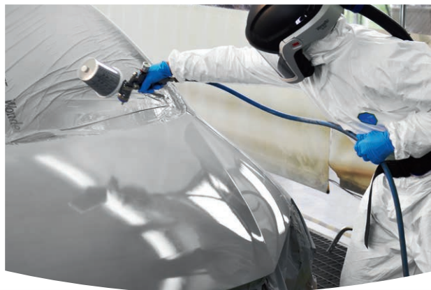
Schnelles Auftragen ohne Abluftzeiten zwischen den Spritzgängen.
