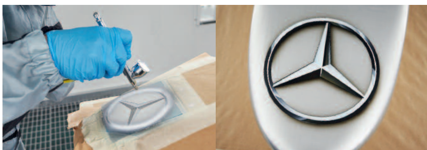
Enkele van de 30 stappen in het proces die vereist zijn om de iconische Mercedes-Benz-ster te airbrushen.
