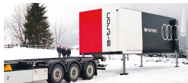
1 Die Versorgung der E-Autoflotte beim Hahnenkamm-Rennen in Kitzbühel war der erste Härtestest für den Göbel-Container. 2 Nach dem Lösen vom Sattelschlepper steht der LiftContainer 3.0 selbstständig auf einer Höhe von 1,12 Meter.
