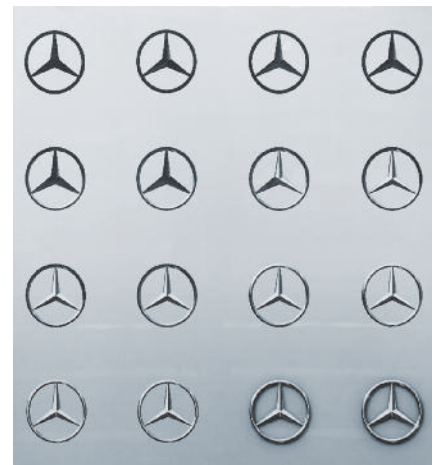
Zum Airbrushen des kultigen Mercedes-Benz-Sterns sind 30 Einzelschritte notwendig: exemplarisch einige der Stadien.
